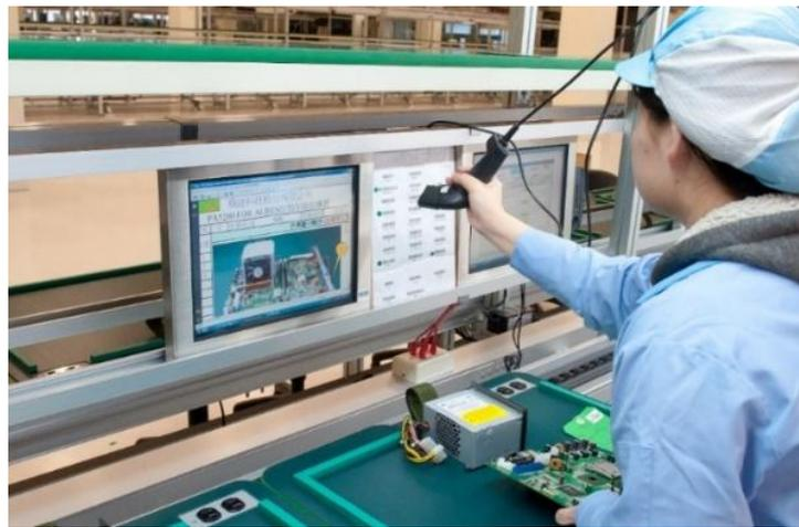
除了品管檢驗，員工的紀律和對組裝的熟練度是確保品質的另一個重要環節，除了不定期執行 5S，飛捷更要求直接人員在進入產線時必須戴上靜電環、穿上靜電鞋，利用靜電報到台排除多餘的電以避免對電子產品造成損害。在執行正確度方面，林口工廠的組裝作業指導書已全面 E 化，每位直接人員的前方皆有一台電腦顯示作業工單的 SOP，且能透過刷卡機制，驗證該員已完成機種的教育訓練才得以進行操作，E 化作業除了提升產能，也能減少人為導致的品質異常。
